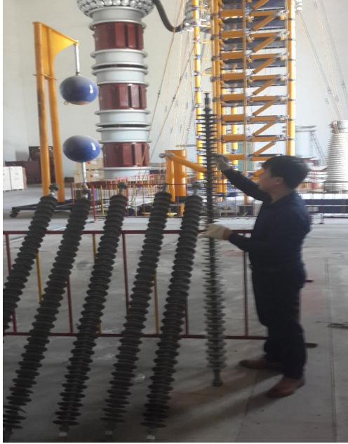
Hình 1: Chuẩn bị và thử nghiệm với các mẫu chuỗi cách điện silicone
