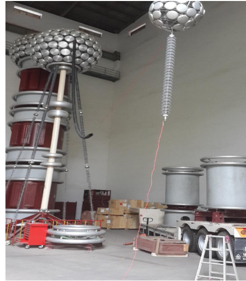
Hình 2: a) Thử nghiệm xung sét chuỗi cách điện, cao tần số công nghiệp b) Thử nghiệm xoay chiều tăng
