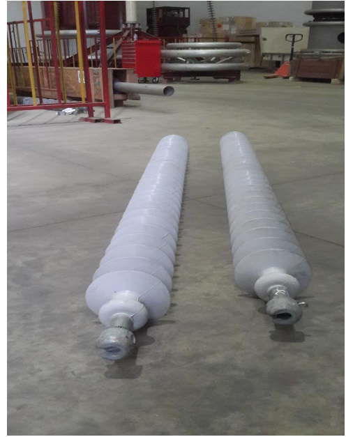
Hình 1: Chuẩn bị và thử nghiệm với các mẫu chuỗi cách điện silicone
