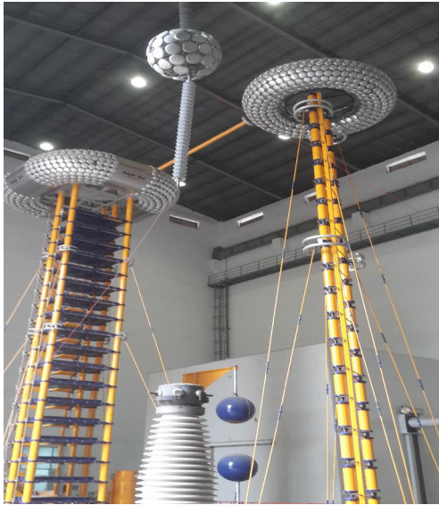
Hình 2: a) Thử nghiệm xung sét chuỗi cách điện, cao tần số công nghiệp b) Thử nghiệm xoay chiều tăng
